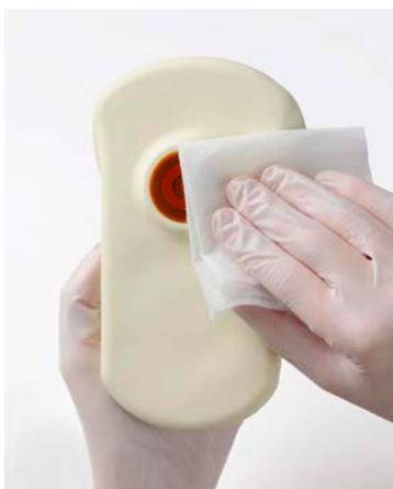
Figura 17. Limpieza de la parte inferior de SEM Scanner
