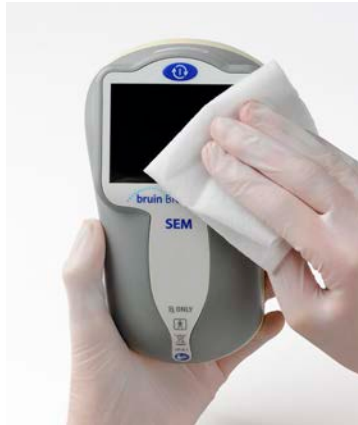
Figura 18. Limpieza de la parte superior de SEM Scanner
