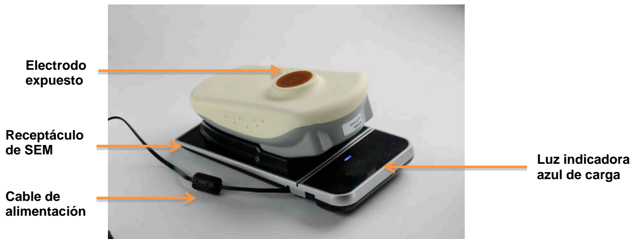
Figura 7. Colocación correcta de SEM Scanner sobre el soporte de carga
