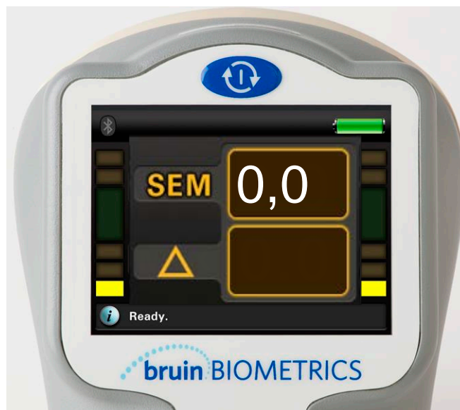
Figura 10. O SEM Scanner está totalmente carregado, inicializado e pronto a ser utilizado
