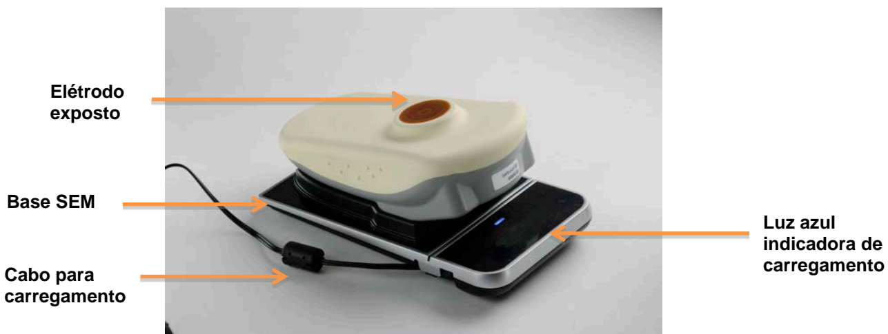
Figura 7. Posicionamento correto do SEM Scanner sobre a base para carregamento
