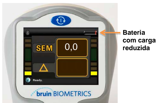
Figura 6. O medidor de carga da bateria situa-se no canto superior direito do ecrã do SEM Scanner
