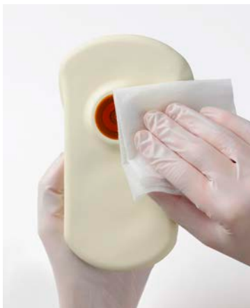
Figura 17. Limpeza da zona inferior do SEM Scanner
