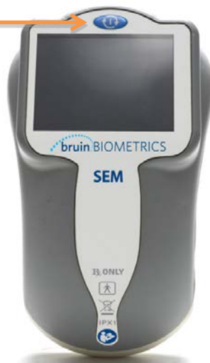
Abbildung 1. SEM-Scanner, Draufsicht mit Display und Aktionstaste
