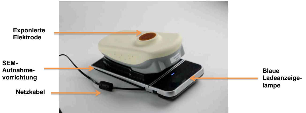
Abbildung 7. Korrekte Positionierung des SEM-Scanners auf der Ladematte
