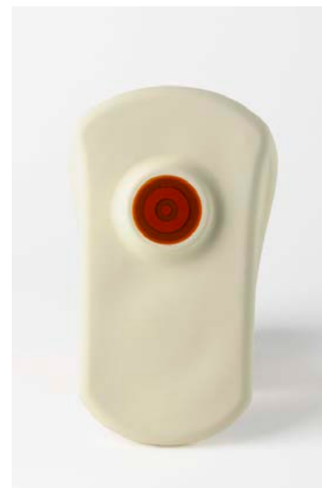
Abbildung 2. Die Elektrode an der Unterseite des SEM-Scanners
