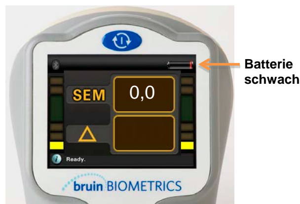
Abbildung 6. Die Batterieanzeige befindet sich in der oberen rechten Ecke des SEM-Scanner-Displays.
