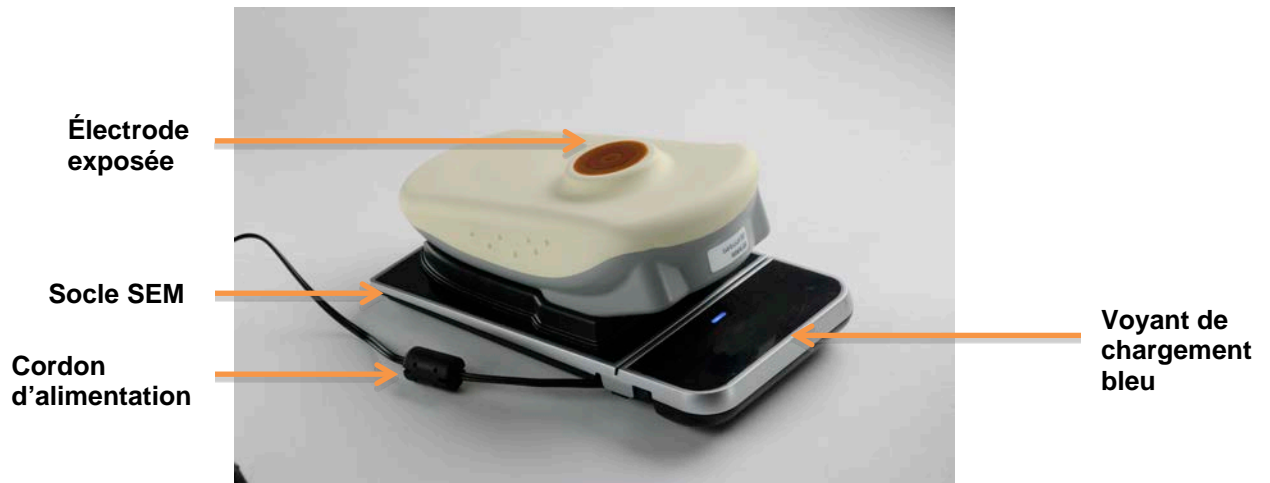
Figure 7. Positionnement correct du Scanner SEM sur le tapis de recharge
