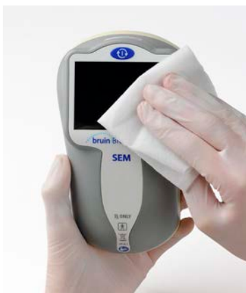
Figure 18. Nettoyage du dessus du Scanner SEM
