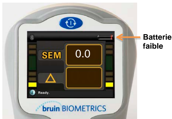
Figure 6. La jauge de batterie se situe en haut à droite sur l'écran du Scanner SEM
