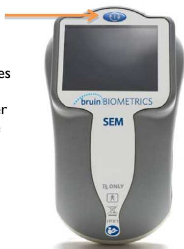
Figure 1 – Vue de dessus du SEM Scanner présentant l'affichage et la touche d'action
