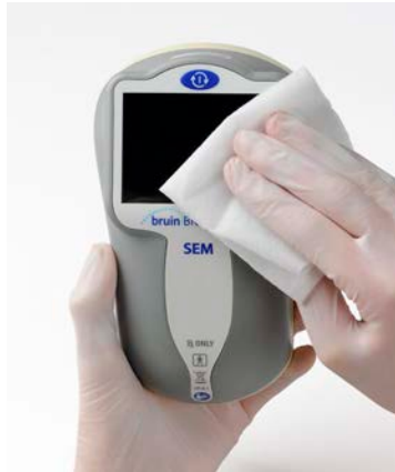
Figure 18 – Nettoyage du dessus du SEM Scanner
