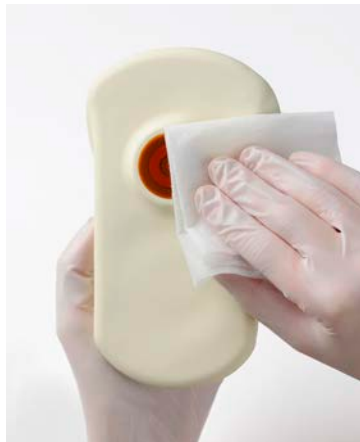
Figure 17 – Nettoyage du dessous du SEM Scanner
