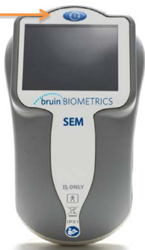
Afbeelding 1. Bovenaanzicht SEM Scanner met scherm en actieknop
