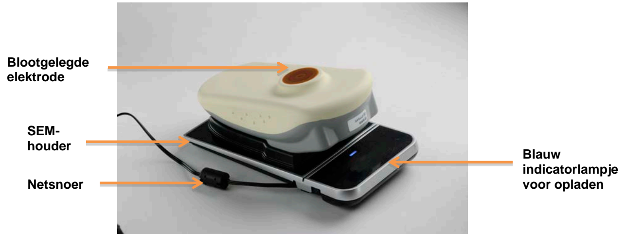
Afbeelding 7. Correcte positie van de SEM Scanner op de oplaadmat
